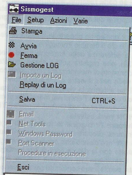
Fig.15 Cliccando sulla scritta File, presente sulla barra in alto dei menu, si apre questa finestra che contiene, tra gli altri, anche il comando per effettuare il Replay di un Log, cioè di un sismogramma.
