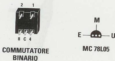
Fig. 10 Connessioni dei Pesi 1-2-4-8 del commutatore binario S1 (il terminale C è il cursore centrale) e sulla destra le connessioni E-M-U dell'integrato MC.78L05.
