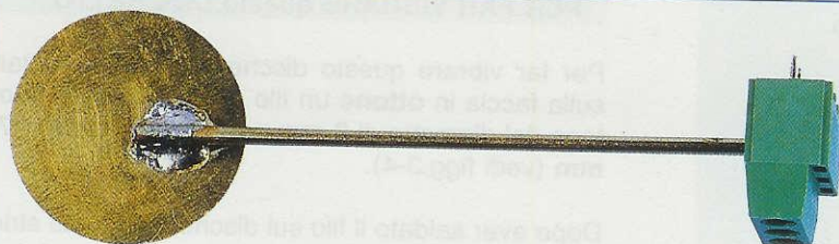
Fig.4 Sull'estremità di questo filo va fissato un peso (vedi morsetti) che servirà per trasmettere le vibrazioni al dischetto piezoelettrico.
