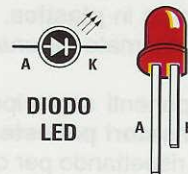
Fig.7 Le connessioni dei due integrati LM.358 e NE.555 viste da sopra e con la tacca di riferimento a U rivolta verso sinistra. Le connessioni del transistor BC.547 sono viste da sotto. Il terminale più lungo del diodo led è l'Anodo.
