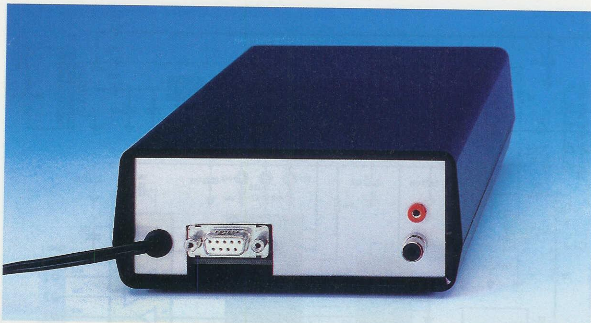
Fig.5 Dal pannello posteriore del mobile esce il connettore femmina CONN.1 che vi serve per collegare il connettore maschio del cavo seriale. Sul lato destro del pannello sono visibili la boccola d'ingresso per il cavetto schermato e quella d'uscita per i 20 volt.
